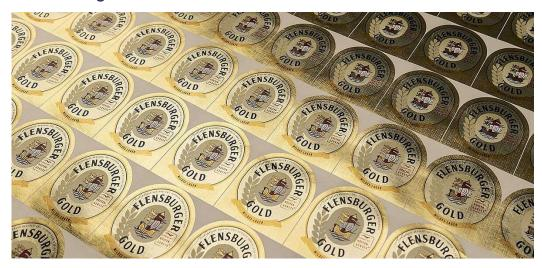
Umgesetzt wurde die Etikettenveredelung mittels ECOFIN®. Die Kalttransfer-Dekoration aus dem Hause KURZ besticht durch brillante Druckergebnisse auf einem dünnen 10-µm-Transferträger (früher 12 µm), bei dem nun 17 Prozent weniger Material verbraucht wird. Gedruckt wird auf weißes, leicht strukturiertes statt wie bisher auf überwiegend metallisiertes Papier – somit ist der Wunsch erfüllt, nachhaltiger und mit dem bereits gut etablierten Partner Druckerei Ellerhold auch regionaler zu agieren.
